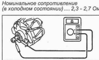
2. Убедитесь в отсутствии проводимости между контактными кольцом и ротором.
