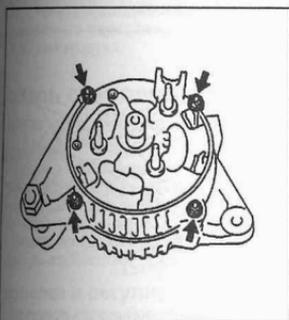
б) Снимите корпус.
